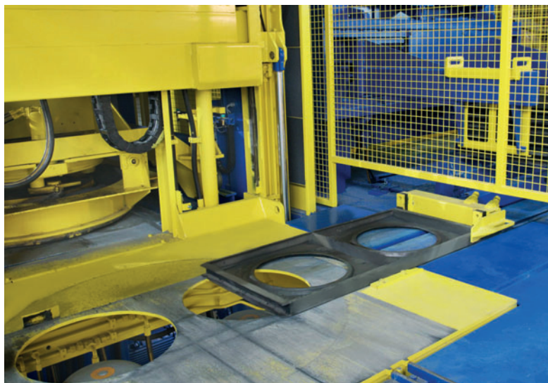
Автоматическая подача опорной муфты на производственную установку
